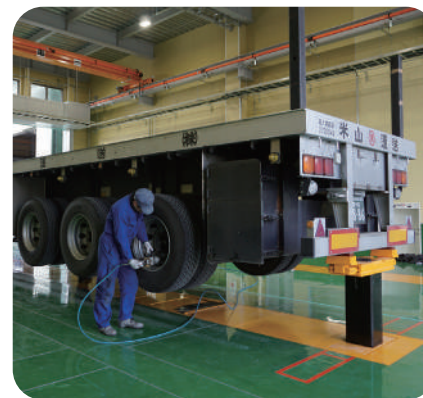
2柱リフトを使った整備の様子
