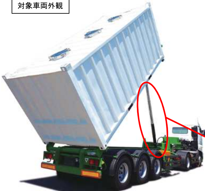
ダンプアップ機能付きコンテナセミトレーラ
