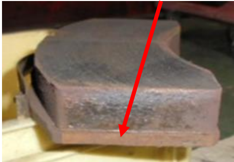
不具合例 ブレーキパッドのパッドベースに錆
