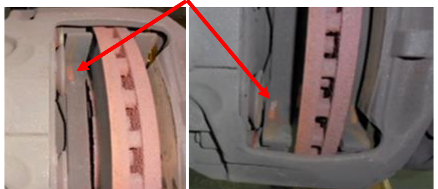
キャリアのブレーキパッド受け部に錆
