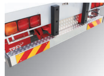
●突入防止リヤバンパー 上面アルミ縞板付(3軸車)
