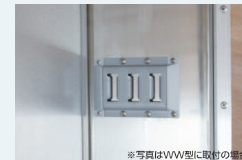
●ラッシングレール リヤフレーム部 (ラッシングビーム収納用) ※写真はVV型に取付の場合
