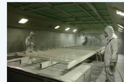
④ メラミン塗料を吹付けします
