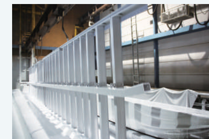
② 電着槽に投入し電着塗装を行います
