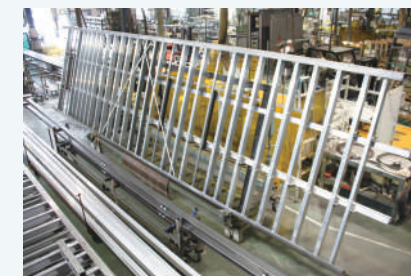
① 床フレーム組立て (塗装前)
