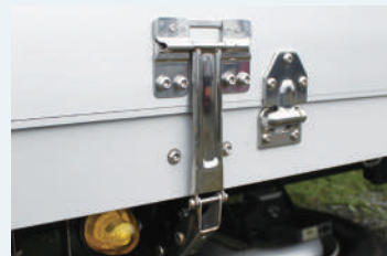
●アオリドア ステンレス製(上下逆段用) / アオリ開閉補助装置 ステンレス製
