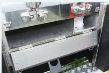
●後部格納庫 (ジョロダーリフター格納庫兼用) ステンレス製
