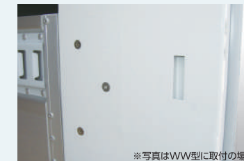
●リヤフレーム切欠き (ラッシングビーム収納用) ※写真はVV型に取付の場合
