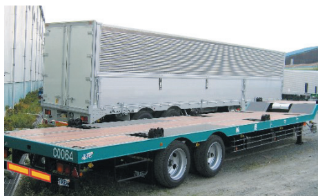
床板 全面張り アピトン
