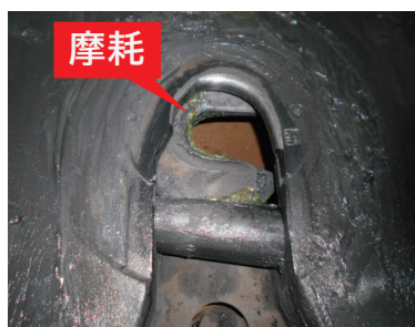
第五輪カプラの摩耗例
