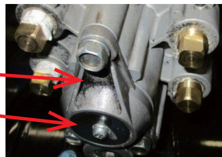
黒くオイルで汚れた リレーエマージェンシーバルブの排気ポート
