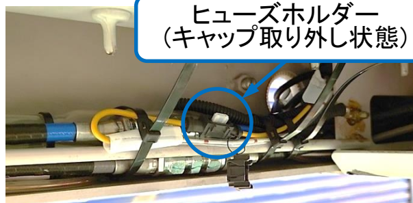
図2. フロントレール裏側左(7極ソケット配線部)
