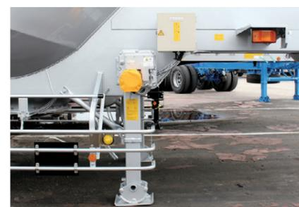
電動補助脚(NEL755)操作盤右側
