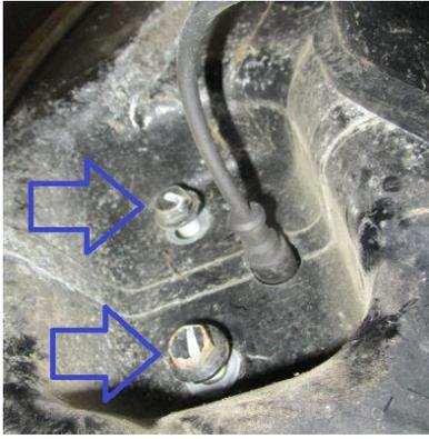
ショートソケットのみでは、ABSセンサーを痛めてしまうので13mm6角ソケットにショートエクステンション接続して工具を逃がして下さい。
