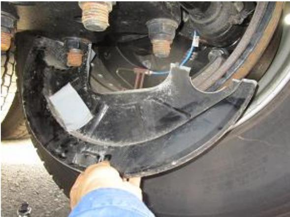
バックプレート(下側)を外すと温度センサーが見えます。
