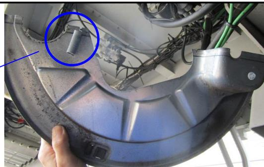
vi) バックプレート(上側)(下側)を取付け、
