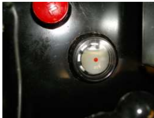
②作動油内に海水が混入し白濁し量が増えています。
