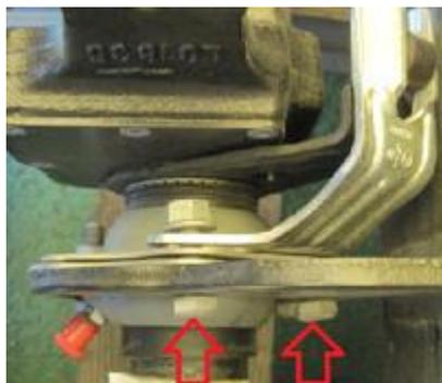
シエイブドプレート2本の固定ねじを緩めて、コントロールレバーを動かし、ゼロ点を合わせる。
