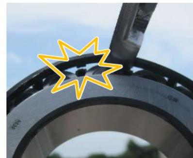
・ベアリングを軽油等でキレイに洗浄し、完全に乾燥させてから、点検する。
