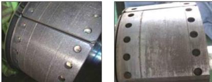
ドラムとライニングの間に異物が噛み込むことにより発生します。
