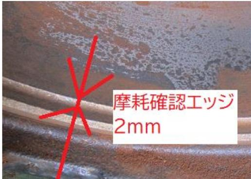
・ドラムの摩耗確認エッジにより、適量な残厚がある事を確認します。
