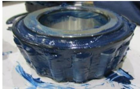
※少量のベアリンググリスで潤滑させるため必ず純正グリスを使用下さい。
