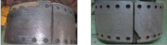
【摩擦面の亀裂】 使用不可。但し表面をペーパーで軽く研磨して消える亀裂は使用可。
