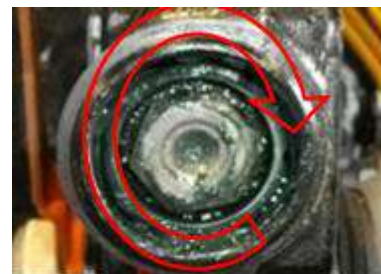
調整ナット ブレーキ解放時 カチッと1ノッチ詰まる
