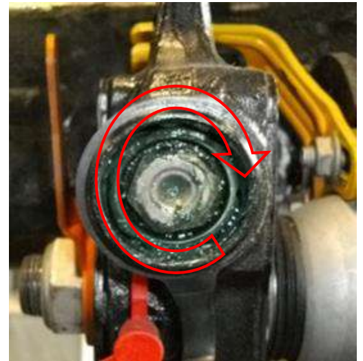
調整ナット ブレーキ解放時 カチッと1ノッチ詰まる
