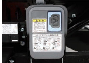
庫外リモコン追加 ※リモコン収納用に樹脂ボックスが装着されます (収納状態での操作も可能です)。
