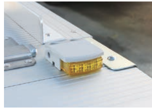
プラットホーム上面先端部ランプ取付
