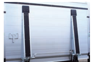
クッションゴム取付 (写真はスチフナ+先端部取付)
