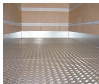
●床材 鋼板張り
