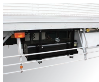
●冷凍機用燃料タンク (冷凍機メーカー手配)
