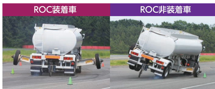
実験は35～45キロ超の進入速度でJターン路に進入。実験のため補助輪が取付されています。
