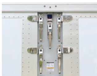
●アオリロック/羽根押さえ ステンレス製
