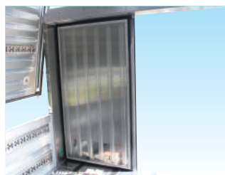
●リヤドア 断熱リヤドア+アルミスノコ縦張り
