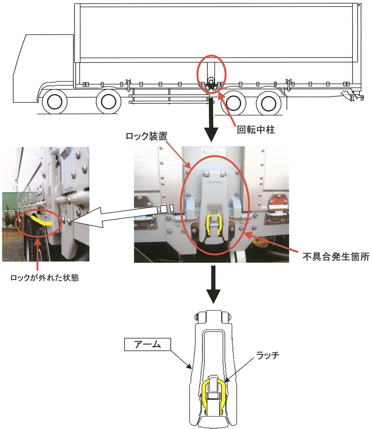
ウイングトラックの荷台あおりを固定するための回転式中柱において、荷台内側から強い横荷重を受けた場合、当該中柱固定用ロック装置の頑健性が不足しているため、当該ロック装置のラッチが外れ、車両の全幅が道路運送車両の保安基準を満足しない。
