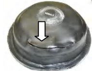
劣化、破損したダイヤフラム
