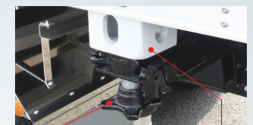
ボデーをガッチリ緊締する ツイストロック コーナーキャスティング
